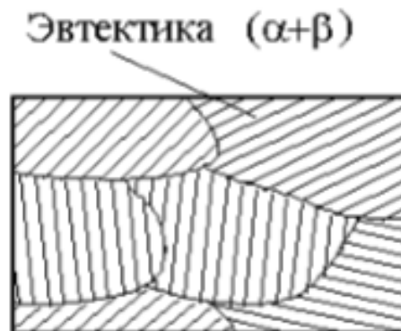
Рисунок 9 – Микроструктура эвтектического сплава (схема)
